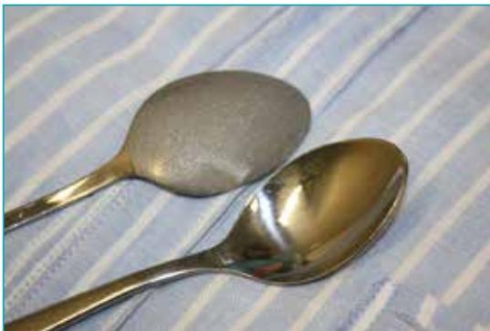
Abbildung 6: Sandgestrahlter Kaffeelöffel als Augenschutz. Die Sandstrahlung verhindert eine versehentliche Reflexion des Laserstrahls.
